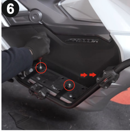
Paket içerisinden çıkan pul ve cıvataları kullanarak koruma demirini hizalayıp 4mm alyan ile monte ediniz. (Using the washers and bolts included in the package, align the engine guard and install it with a 4 mm allen.)
