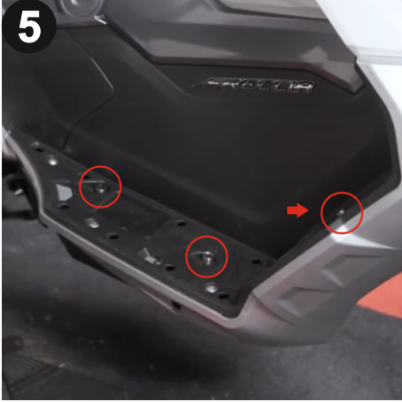
Paket içerisinden çıkan burçları gösterildiği gibi yerleştiriniz. (Position the bushings as shown.)
