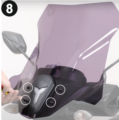
8 Camı orijinal civatalarıyla monte ediniz. (Mount the glass with its original bolts.)
