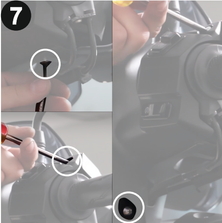
7 Çıkardığınız civataları tekrardan yıldız torna-vidayla takınız. (Reattach the bolts you removed with a Phillips screwdriver.)
