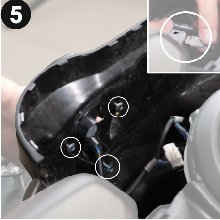
5 Grenajın iç kısmındaki orijinal civataları tekrardan takıp kablo bağlantısını yapınız. (Reinstall the original bolts on the inside of the fairing and connect the cable.)
