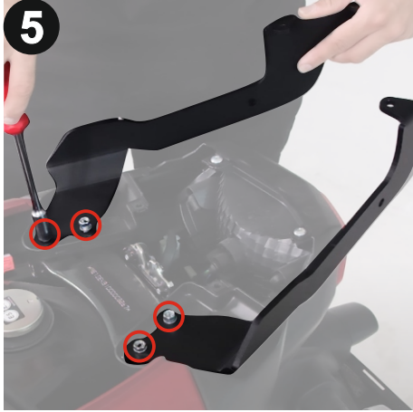
Yerleştirdiğiniz vidaları 10mm tornavida kullanarak sıkınız. (Tighten the inserted screws using a 10mm screwdriver)
