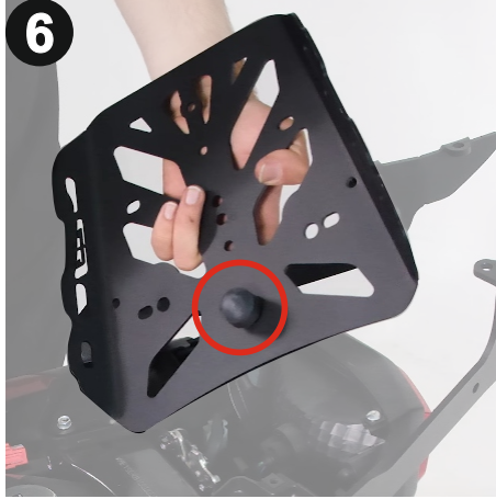
Paket içinden çıkan plastik takozu gösterilen şekilde çanta tablasına yerleştiriniz. (Place the plastic spacer from the package onto the luggage rack plate as shown.)
