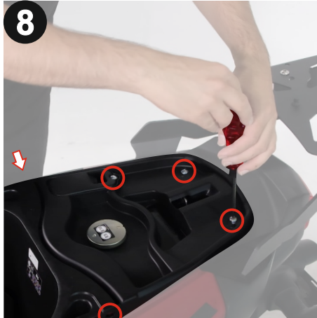
Depo grenajını yerleştiriniz, gösterilen plastik parçayı yerine koyunuz ve Grenajı yıldız tornavida ile monte ederek işlemi tamamlayınız. (Reinstall the tank fairing, place the indicated plastic part into position, and complete the process by fastening the fairing with a Phillips screwdriver.)
