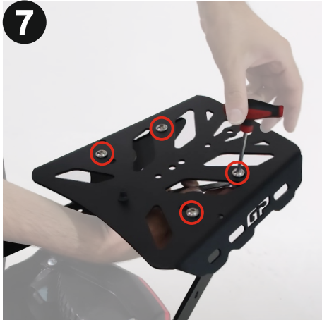
Ürün tablasını yerleştiriniz ve paket içerisinden çıkan vida pul ve somunu takıp 4mm alyan ve 10mm anahtar yardımı ile sabitleyiniz. (Position the product base plate, then insert the bolt, washer, and nut from the package. Secure it using a 4mm Allen key and a 10mm wrench.)
