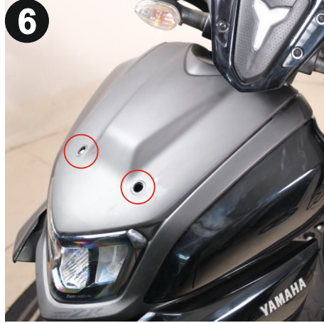
6 Ürünü yerleştirin ve plastik tıpaları çıkartınız. (Place the product and remove the plastic plugs.)
