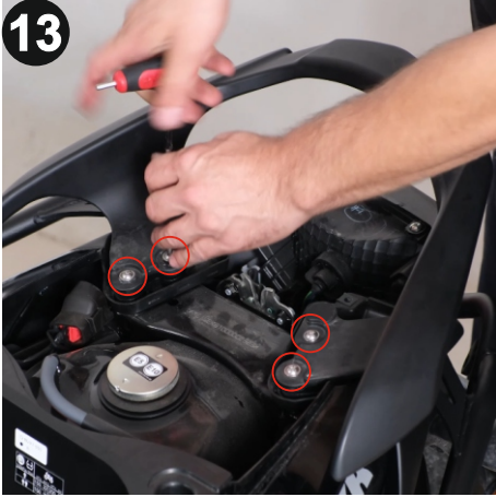
13 Arka tutamacı gösterildiği gibi konumlandırın ve paket içinden çıkan cıvatalarla 4mm alıyan kullanarak sabitleyiniz. (Position the rear handle as shown and secure it using the bolts included in the package, using a 4 mm allen.)
