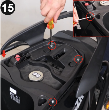
15 Plastik parçayı yerine yerleştirin ve yıldız tornavida kullanarak orijinal cıvatalarla sabitleyiniz. (Place the plastic part in position and secure it with the original bolts using a Phillips screwdriver)
