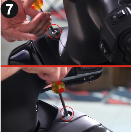
7 Kapağı, yıldız tornavida kullanarak orijinal cıvatalarıyla yerine takınız. (Use a Philips screwdriver to secure the cover with the original bolts)
