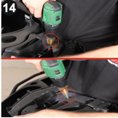
14 Plastik parçayı gösterildiği gibi deliniz. (Drill the plastic part as shown.)
