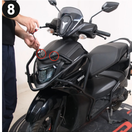
8 Koruma demirinin ön kısmını gösterildiği gibi konumlandırınız ardından paket içerisinde çıkan cıvata ve uzun burçlarla 4mm alyan kullanarak gösterildiği gibi sabitleyiniz. (Position the front part of the crash bar as shown, then secure it using the bolts and long spacers included in the package, using a 4 mm allen as shown.)
