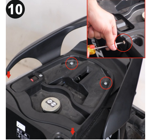
10 Yıldız tornavida kullanarak orijinal cıvataları sökünüz ve kapağı çıkartınız. (Remove the original bolts using philips screwdriver and take off the cover)
