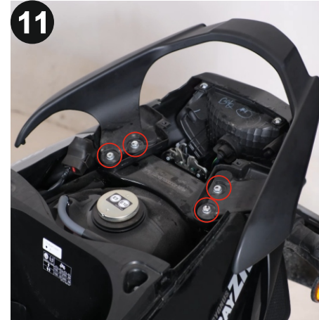
11 10mm Tornavida kullanarak orijinal cıvataları sökünüz ve arka tutamacı çıkartınız. (Remove the original screws using 10mm screwdrivers and take off the rear handle)
