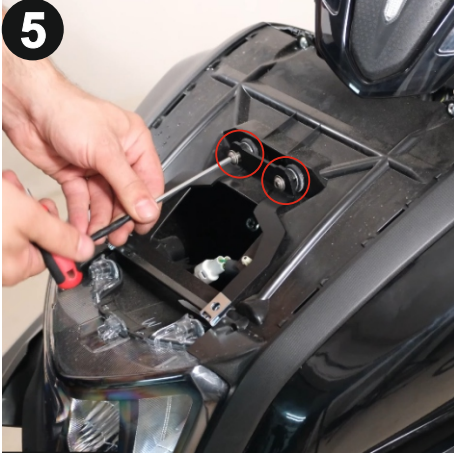
5 Aparatı paket içerisinde çıkan cıvatalarla gösterildiği gibi 4mm alyan kullanarak monte ediniz. (Install the bracket using the bolts included in the package, using a 4 mm allen as shown)
