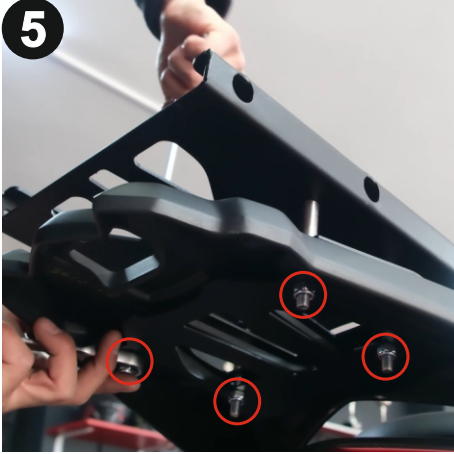
5 Yerleştirdiğiniz vidalara somun takıp 6mm alyan ve 13mm anahtar kullanarak sabitleyiniz. (Secure the installed bolts by fitting nuts and tightening them using a 6mm allen and a 13mm wrench.)
