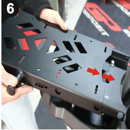
6 Ürünün üst kazağını gösterilen şekilde, sağ taraftaki pimi çekerek yerleştiriniz. (Fit the upper rail of the product as shown by pulling the pin on the right side.)
