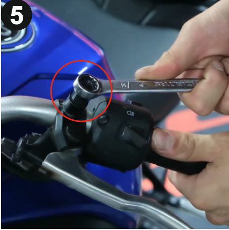
Motosikletinizin aynasını ve ayna ayağını 14mm anahtar ile çıkartınız. (Remove your motorcycle's mirror and mirror mount using a 14 mm wrench.)
