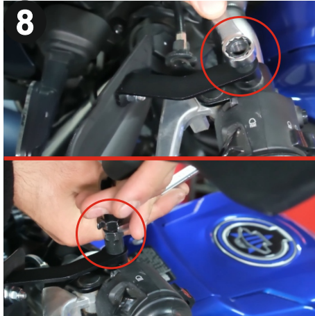
Ürünün ayna bağlantısını monte etmek için ayna ayağı ve aynayı gösterildiği gibi 14mm anahtar ile sıkınız. (Install the product's mirror mount, tighten the mirror mount and the mirror as shown using a 14 mm wrench.)
