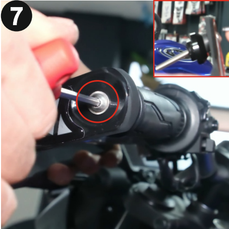
Ürünü paket içerisinde çıkan vida, plastik conta ve orijinal gidon topuzu ile gösterilen şekilde hizalayınız 4mm alyan ile sabitleyiniz. (Align the product as shown using the screw and plastic washer included in the package together with the original handlebar end weight, and secure it with a 4 mm allen.)
