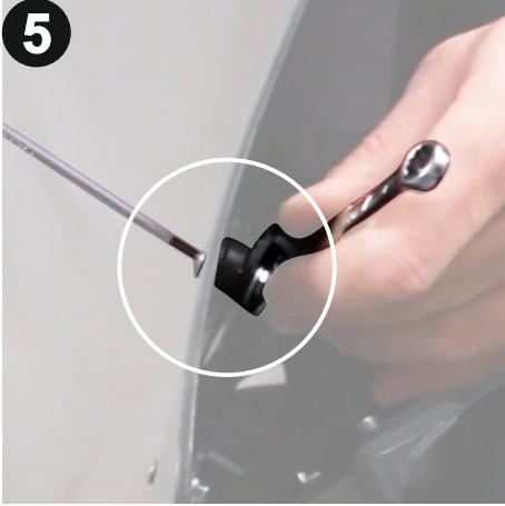
3 alyan ve 8 anahtar yardımı ile takmış olduğunuz pul başlı vidaları sıkınız. (Tighten the flat head screws you have installed using a 3 Allen wrench and an 8 spanner.)
