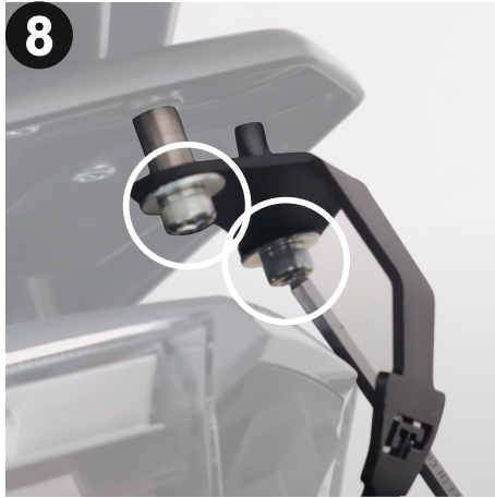
Koruma demirinin arka kısmını sabitlemek için gösterildiği gibi paketten çıkan cıvata, pul ve burçları kullanıp 6 alyan yardımı ile monte ediniz. (To secure the rear part of the protective iron, use the bolt, washer, and bushing from the package as shown, and assemble them with a 6mm Allen wrench.)
