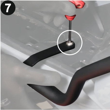
Cıvatayı 4 alyan ile sıkınız. (Tighten the bolt with a 4mm Allen wrench.)
