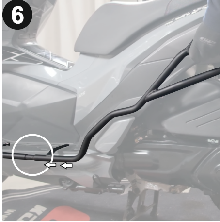
Koruma demirinin alt kısmını gösterildiği gibi konumlandırınız. (Position the bottom part of the protective iron as shown.)
