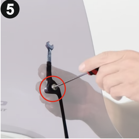
Ürünü 3mm alyan ve 8mm anahtar kullanarak sabitleyiniz. (Secure the product using a 3mm allen and an 8mm wrench.)
