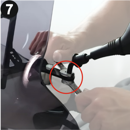
Motosikletinizin aynasını paket içerisinden çıkan somunu kullanarak, 14mm anahtar ve 17mm anahtar ile geri takınız. (Reattach your motorcycle mirror using the nut provided in the package, with a 14mm and a 17mm wrench.)
