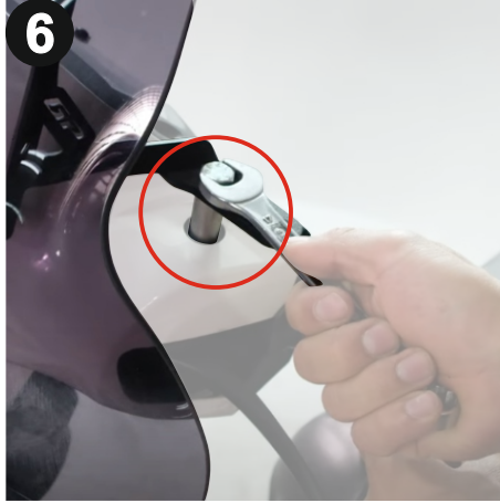
Cam ayaklarının bağlantısını 17mm anahtar ile sabitleyiniz. (Tighten the windshield bracket connections using a 17mm wrench)
