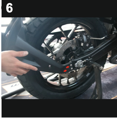
6 Ürünü hizalayınız ve gösterilen şekilde yerleştiriniz. (Align the product and position it as shown.)
