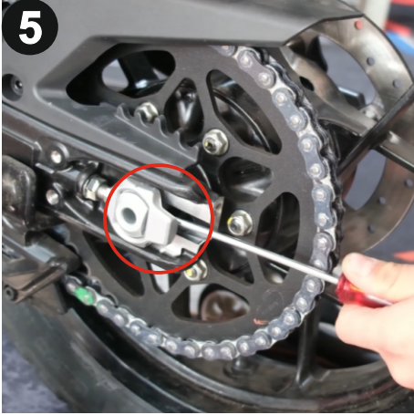
5 Ürünü monte edebilmek için gösterilen parçayı tornavida yardımı ile ittiniz. (Push the shown part using your hand or a screwdriver to allow product installation)
