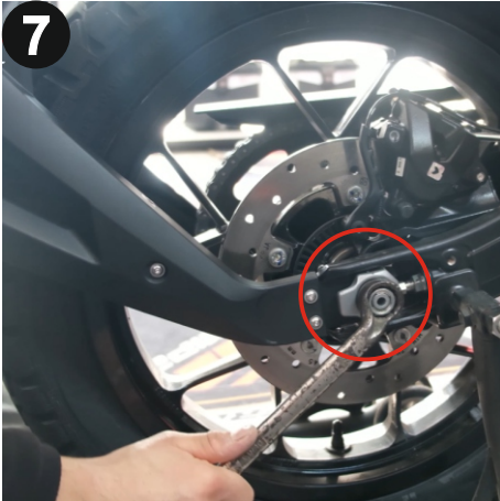
7 İlk aşamada gevşettiğiniz vidayı 24mm kapalı ağız anahtar ile geri sıkarak montaj işlemini tamamlayınız. (In the first step, tighten the loosened bolt again using a 24 mm box wrench to complete the installation.)
