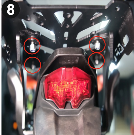
Ürünün montajını yerleştirdiğiniz vidaları 4mm alyan ve 10mm anahtar ile sıkarak tamamlayınız. (Complete the product installation by tighten the installed bolts using a 4mm allen and a 10mm wrench)
