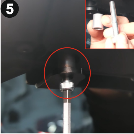
Gösterilen demirin alt bağlantısını yine paket içinden çıkan vida ve burcu kullanarak 6mm alyan ile monte ediniz. (Install the lower connection of the indicated bracket using the bolt and spacer supplied in the package with a 6mm allen.)
