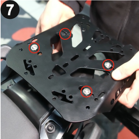
Çanta demirinin tablasını gösterilen şekilde hizalayınız ve paket içerisinden çıkan vidaları gösterilen şekilde yerleştiriniz. (Align the luggage rack plate as shown and place the bolts supplied in the product pack indicated positions.)
