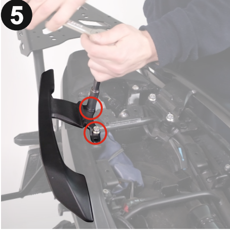
Gevşettiğiniz vidaları gösterilen şekilde 12mm lokma anahtar ile sıkınız. (Tighten the loosened bolts as shown using a 12mm socket wrench.)
