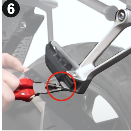
Artçı ayaklığının pimini pense yardımı ile pimin bağlı olduğu vidayı ise elinizi kullanarak çıkartınız. (Remove the passenger footpeg pin using pliers, and take out the screw holding the pin by hand.)
