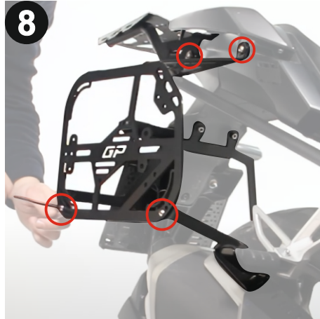
Ürünü hizalayıp paket içerisinden çıkan vida ve somunlar ile 4mm alyan ve 10mm anahtar kullanarak montaj işlemini tamamlayınız. (Align the product and complete the installation using the bolts and nuts provided in the package, along with a 4mm Allen key and a 10mm wrench.)
