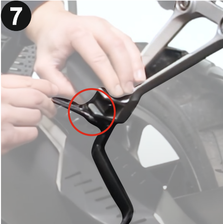
Çanta bağlantı aparatını gösterilen şekilde yerleştiriniz ve ürün paketi içerisinde çıkan vida ve somun ile 10mm anahtar kullanarak sıkınız. (Position the luggage mounting bracket as shown, and tighten it using the bolt and nut provided in the package with a 10mm wrench.)
