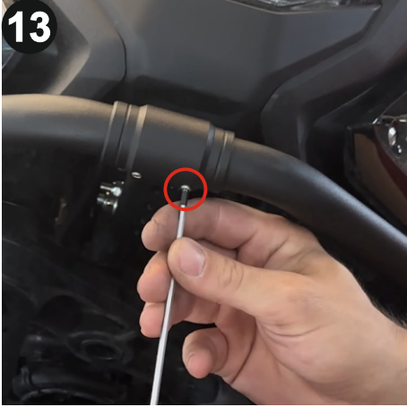
13 Koruma demiri ile bağlantı aparatını 3mm alyan ile sabitleyiniz. (Secure the crash bar to the bracket using a 3mm allen)
