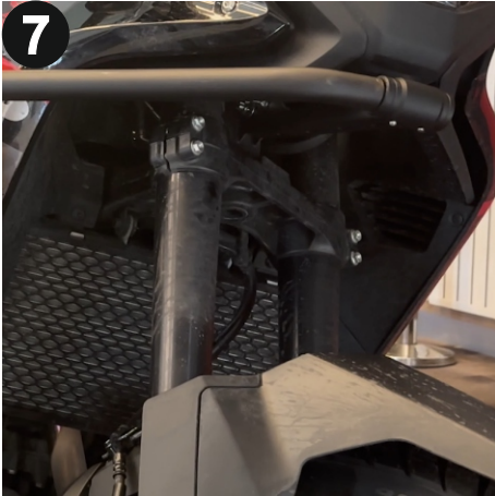
7 Koruma demirini bağlantı aparatına gösterilen şekilde yerleştiriniz. (Align the crash bar as shown and pass it through the mounting bracket.)
