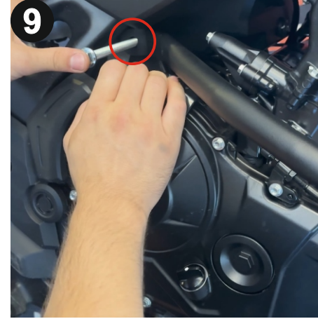
9 Ürünü yerleştirdikten sonra paket içerisinde çıkan vida ve saplamayı yerleştiriniz. (After placing the product, install the supplied bolt and stud.)
