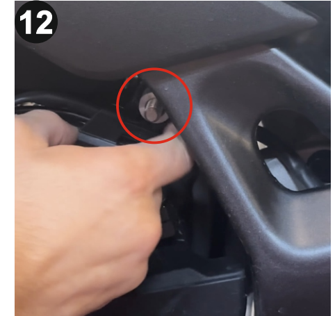
12 Daha öncesinde yerleştirdiğiniz saplama vidanın karşılığına paket içerisinde çıkan burcu yerleştiriniz ve koruma demirini hizalayınız. (Insert the bushing included in the package onto the previously installed stud bolt, then align the crash bar.)
