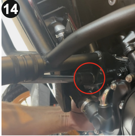
14 Paket içerisinden çıkan diğer vidayı gösterilen şekilde yerleştiriniz ve 17mm lokma anahtar ile sabitleyiniz. (Install the other supplied bolt as shown and tighten it using a 17mm socket wrench)
