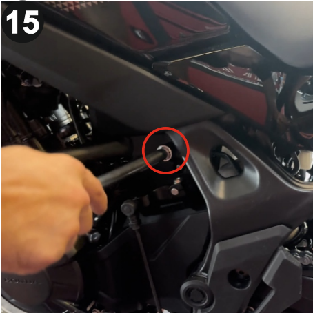
15 Saplama vidasının iki somununu da elinizle sabitledikten sonra 15mm lokma anahtarla saplamayı sıkınız ve montajı tamamlayınız. (After hand-tightening both nuts on the stud bolt, tighten the stud using a 15 mm socket wrench and complete the installation.)
