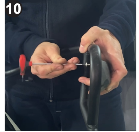
Koruma demirinin ön parçasının pedlerini gösterilen şekilde 3mm alyan ile monte ediniz. (Install the pads of the front part of the protection bar as shown using a 3mm Allen key.)
