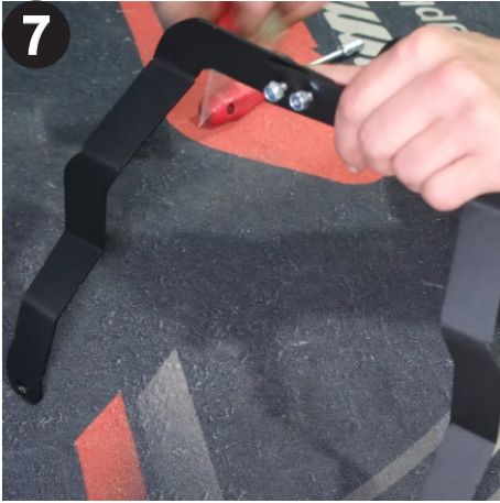
Gösterilen kafa bağlantı aparatını, gösterilen şekilde 4mm alyan ve 10mm anahtar yardımıyla birleştiriniz. (Assemble the indicated head mounting bracket as shown using a 4mm Allen key and a 10mm wrench.)
