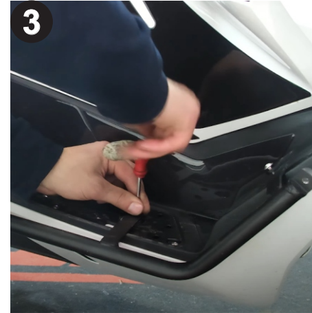
3 Koruma demirini hizalayınız ve yerleştiriniz. 4mm alyan ile montajını yapınız. (Align and place the engine protector crash bar. Mount is using a 4mm allen.)
