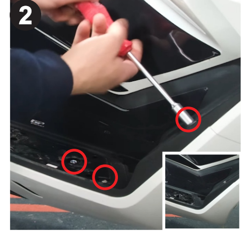
2 Basamak üzerinde gösterilen iki vidayı 10mm tornavida ile sökünüz. Paket içerisinden çıkan burçları yerleştiriniz. (Remove the two screws shown on the footrest using a 10 mm screwdriver. Insert the spacers provided in the package.)
