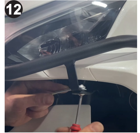
Koruma demiri ön parçası ile bağlantı aparatını paket içerisinden çıkan kısa vida ve 4mm alyan ile 10mm anahtar yardımıyla birbirine monte ediniz. (Mount the front part of the protection bar to the connection bracket using the short screw provided in the package, along with a 4mm Allen key and a 10mm wrench.)
