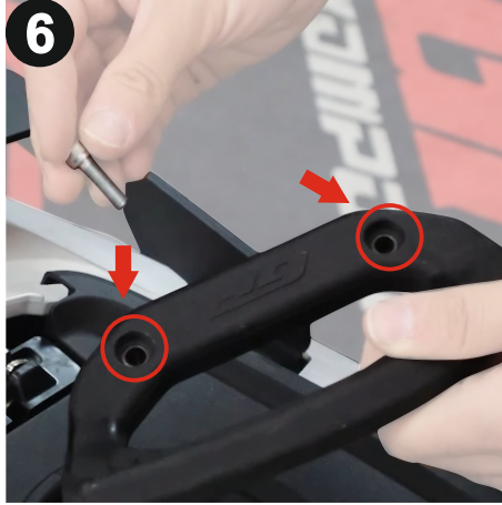
Ürünün artçı tutamaçlarını paket içinden çıkan vidaları kullanarak gösterilen şekilde hizalayınız. (Align the passenger grab handles as shown and use the bolts provided in the package to mount them)
