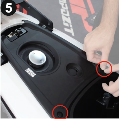
Motosiklet plastik kapağını yerleştirin ve plastik klipsleri monte ediniz. (Reinstall the motorcycle's plastic tank cover and secure the clips)
