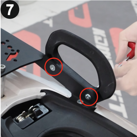
Çanta demirine somunları takarak 5mm alyan yardımı ile monte ediniz. (Attach the nuts to the bag rack and tighten them using a 5mm allen)
