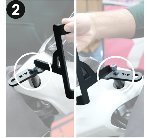
Sağ cam ayağını paket içerisinden çıkan anahtar başlı cıvata ve uzun burçla, sol ayağı ise imbus cıvata ve kısa burçla konumlandırınız. (Position the right glass foot using the bolt with hexagonal head and the long bushing from the package, and the left foot using the hexagon socket bolt and the short bushing.)
