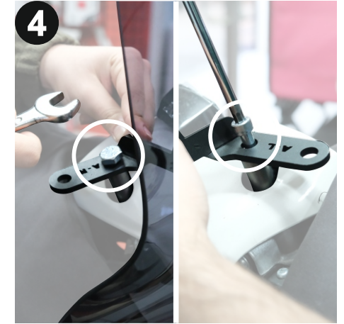
Sağ tarafı (anahtar başlı cıvata ve uzun burç) 17 anahtar ile, sol tarafı (imbus cıvata ve kısa burç) 6 alyan yardımı ile sabitleyiniz. (Secure the right side (bolt with hexagonal head and long bushing) using a 17 wrench, and the left side (hexagon socket bolt and short bushing) using a 6 Allen wrench.)
