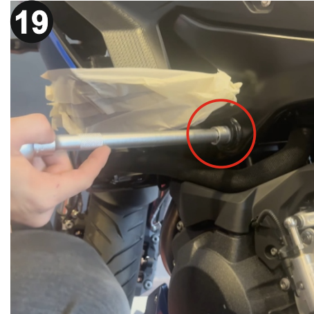
19 Gösterilen vidayı T55 Torx alyan kullanarak çıkartınız. (Remove the shown bolt using a T55 Torx allen)
