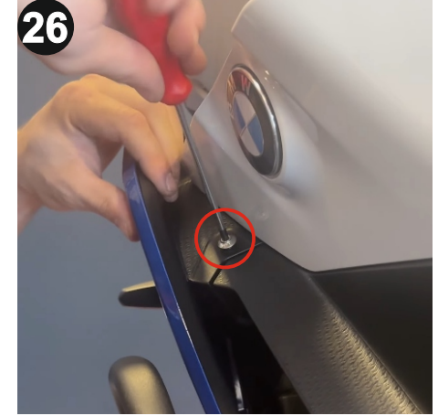
26 Gösterilen vidaları ve grenaj kapağını T25 Torx alyan ile geri monte ediniz. (Reinstall the shown bolts and the fairing cover using a T25 Torx allen)
