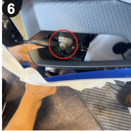
6 Grenajın içinde yer alan vidayı T55 Torx alyan kullanarak çıkartınız. (Remove the bolt inside the fairing using a T55 Torx allen)
