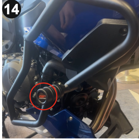
14 Koruma takozunun üzerindeki GP Kompozit 3D jel etiketi yapıştırınız. (Attach the GP Kompozit 3D gel sticker onto the crash frame slider)
