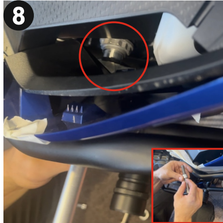
8 Koruma demirini hizalayınız, paket içerisinden çıkan burcu orijinal ya da paket içerisinden çıkan vidayı kullanarak sabitleyiniz ve T55 Torx alyan ile sıkınız. (Align the guard, secure it using the original bolt or the bolt supplied in the package along with the supplied bushing, and tighten it with a T55 Torx allen.)
