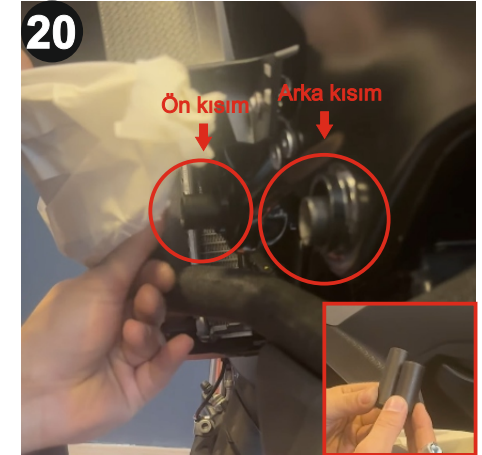
20 Paket içerisinden çıkan burçlardan uzun olanı öne, kısa burcu ise gösterildiği gibi arka bölüme yerleştiriniz. (Place the longer bushing from the package at the front bolt section and the shorter one at the rear bolt section)
