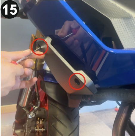
15 Gösterilen vidaları T25 Torx alyan kullanarak çıkartınız ve gösterilen plastik grenaj kapağını sökünüz. (Remove the shown bolts using a T25 Torx allen and remove the plastic fairing cover)
