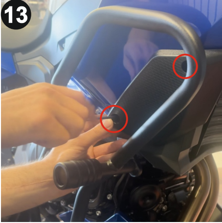
13 Gösterilen vidaları ve grenaj kapağını T25 Torx alyan ile geri monte ediniz. (Reinstall the shown bolts and the fairing cover using a T25 Torx allen)
