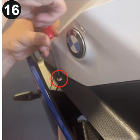
16 Grenajın üst kısmında gösterilen vidayı T25 Torx alyan ile sökünüz ve grenajı açınız. (Remove the bolt shown at the upper part of the fairing using a T25 Torx allen and open the fairing)
