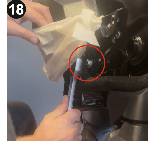
18 Gösterilen vidayı T55 Torx alyan kullanarak çıkartınız. (Remove the shown bolt using a T55 Torx allen)
