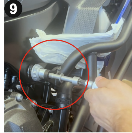
9 Gösterilen vidayı T55 Torx alyan ile sabitleyiniz fakat tamamen sıkmayınız. (Fasten the shown bolt with a T55 Torx allen but do not fully tighten it)
