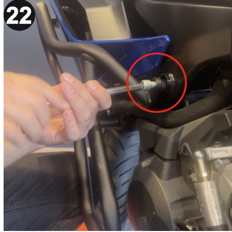
22 Önlem amaçlı kullanılan bantları söküp vidayı 10mm alyan ile hafifçe sıkınız. (Remove the tapes used as a precaution and lightly tighten the bolt with a 10 mm allen.)
