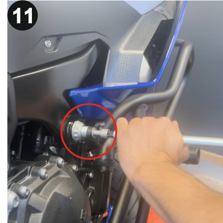
11 Önlem amaçlı yapıştırılan kağıt bantları söküp gevşek bırakılmış vidayı T55 Torx alyan ile tamamen sıkınız. (Remove the paper tapes applied as a precaution and fully tighten the loosened bolt with a T55 Torx allen.)
