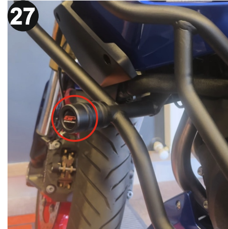
27 Koruma takozunun üzerindeki GP Kompozit 3D jel etiketi yapıştırınız. (Attach the GP Kompozit 3D gel sticker onto the crash frame slider)
