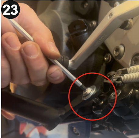
23 Ürünün son bağlantı noktasını gösterilen şekilde paket içerisinden çıkan vida ile 6mm alyan kullanarak tamamlayınız. (Complete the final connection point of the product as shown using the bolt provided in the package and a 6mm allen)
