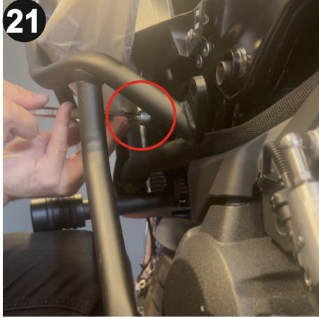
21 Ürünü hizalayınız, paket içerisinden çıkan vidaları kullanarak, 10mm top başlı alyan ile grenaj içindeki vidayı monte ediniz. (Align the product and install the bolt inside the fairing using the bolts provided in the package with a 10mm ball-end allen)
