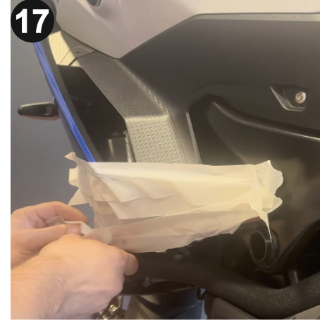
17 Grenajı gösterilen şekilde kağıt ya da silikon bant vb. ürünlerle kapatınız. Olası çizilmelere karşı önlem olarak önermekteyiz. (Cover the fairing as shown using paper tape, silicone tape, or similar products. This is recommended as a precaution against possible scratches.)
