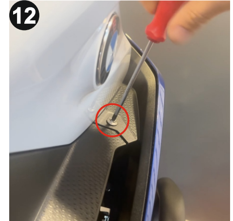
12 Gösterilen vidaları ve grenaj kapağını T25 Torx alyan ile geri monte ediniz. (Reinstall the shown bolts and the fairing cover using a T25 Torx allen)
