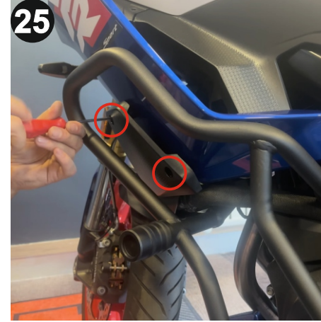
25 Gösterilen vidaları ve grenaj kapağını T25 Torx alyan ile geri monte ediniz. (Reinstall the shown bolts and the fairing cover using a T25 Torx allen)
