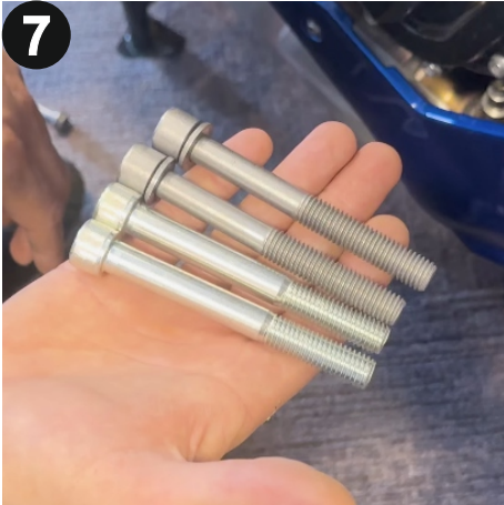
7 Motosikletin sağ tarafı için T55 Torx alyan ile sökülen vidalar için ister orijinal ister paket içinden çıkan vidaları kullanabilirsiniz. (On the right side of the motorcycle, you can use either the original bolts or the ones provided in the package for the bolts removed with a T55 Torx allen)
