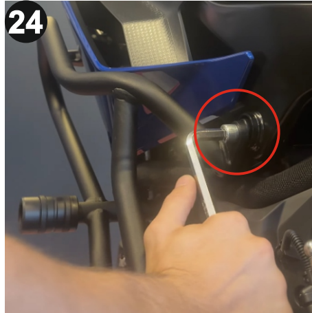
24 Daha önce hafifçe sıkıttığınız gösterilen vidayı 10mm alyan ile sıkılaştırınız. (Fully tighten the previously lightly tightened bolt using a 10mm allen)
