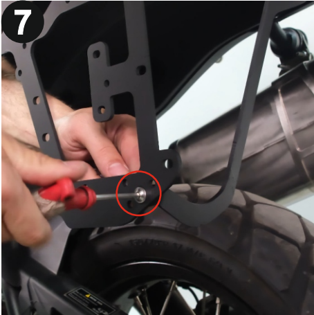
Bağlantı aparatını ürününe hizalayınız, paket içerisinde çıkan vidayı 4mm alyan ve 10mm anahtar yardımıyla takınız. (Mount the connecting bracket aligned with your product, then install the supplied bolt using a 4 mm allen and a 10 mm wrench.)
