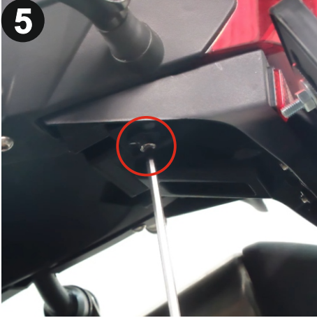
Gösterilen vidayı 5mm alyan kullanarak sökünüz. (Remove the indicated bolt using a 5mm allen)
