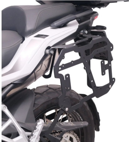
İki tarafıda aynı şekilde monte ediniz. (Install both sides in the same way.)
