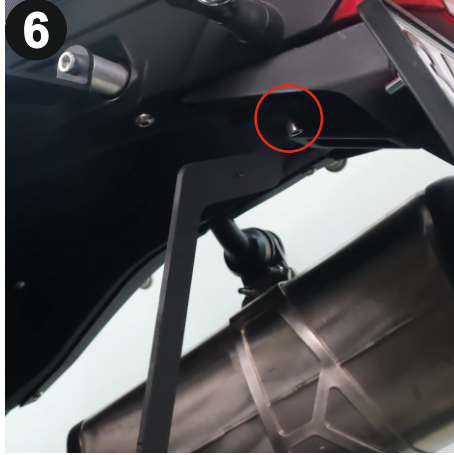
Uzun bağlantı aparatını gösterilen şekilde yerleştiriniz, orijinal vida ve 5mm alyan ile montajı sağlayınız. (Position the long connecting bracket as shown and the installation using the original bolt with 5mm allen)
