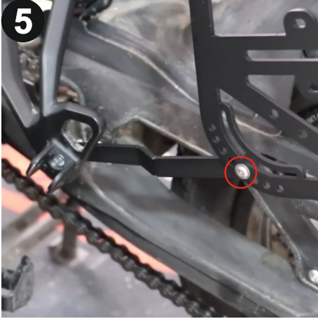
5 Ayaklığa bağladığınız çanta demirinin desteğini 4mm alyan ve 10mm anahtar ile çanta demirine bağlayınız. (Attach the support of the pannier rack that you mounted to the footrest to the pannier rack using a 4 mm allen and a 10 mm wrench.)
