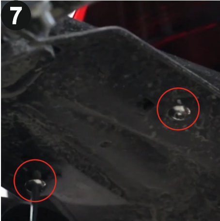
7 5mm alyan ile kuyruğun altındaki vidaları sökünüz. (Remove the bolts under the tail using a 5 mm allen.)
