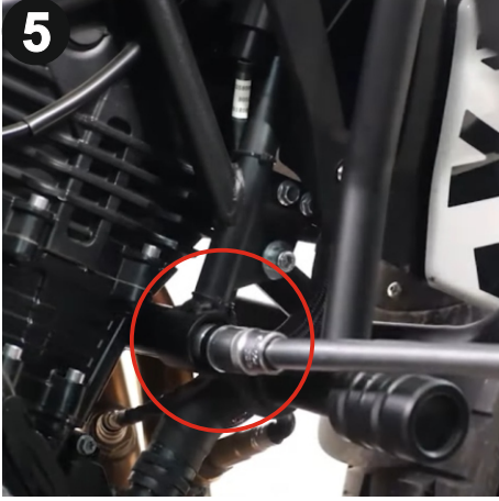
5 17mm anahtar ile koruma demirinin montajını tamamlayınız. (Complete the assembly of the protection bar with 17mm wrench)
