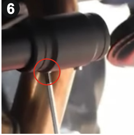
6 Koruma demirinin alt bağlantı aparatını 3mm alyan ile sıkınız. (Attach the lower connection part of the protection bar with a 3mm allen)
